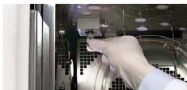
Технология безинструментальной установки колонок ClickTek
